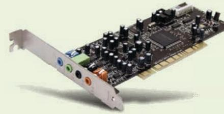
E' la scheda che provvede a trasformare un flusso audio digitale in un segnale analogico in uscita che può' essere riprodotto da un set di altoparlanti collegati ad essa. Effettua anche il processo inverso digitalizzando i segnali analogici inviati ai suoi ingressi
