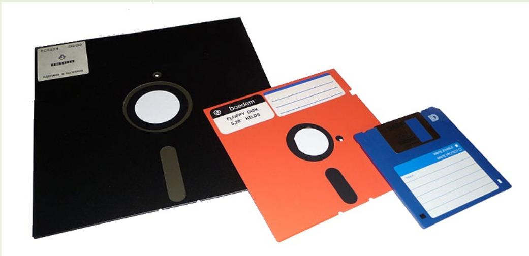
La superficie del dischetto è organizzata in tracce e settori. Le tracce sono le piste circolari ( 1 ) del disco. Un settore comprende più tracce all'interno di una stessa sezione ( 2 ) del disco. I primi floppy disk della storia consentivano la registrazione dei dati soltanto su una faccia del disco.
